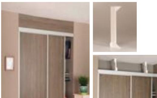
Permet de rattraper une hauteur de 127 à 457 mm correspondant à la différence entre la hauteur de la façade et la hauteur totale sous-plafond. Prévoir de fixer une imposte à 200 mm de chaque extrémité, puis une tous les 500 mm environ.
